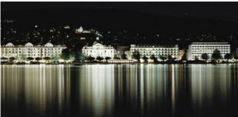
22 Projektoren, 5.9 kW, 1.6 W/m 2 für 500m Seeufer
